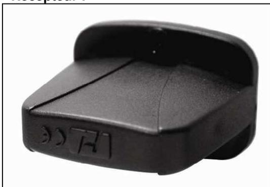
Le récepteur est testé et fixé sur chaque modèle de Z-30PRO. S'il vous plaît ne pas essayer de le détacher. Le récepteur réagit à jusqu'à 5 transmetteurs différents enregistrés avec la machine. Le transmetteur inclus est enregistré avec la machine avant la livraison. Il est possible de l'utiliser directement sans réglage initiale.
